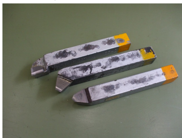
写真2、超硬・ロー付け
