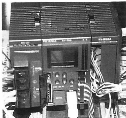
(写真5) 使用した PLC : KV700
